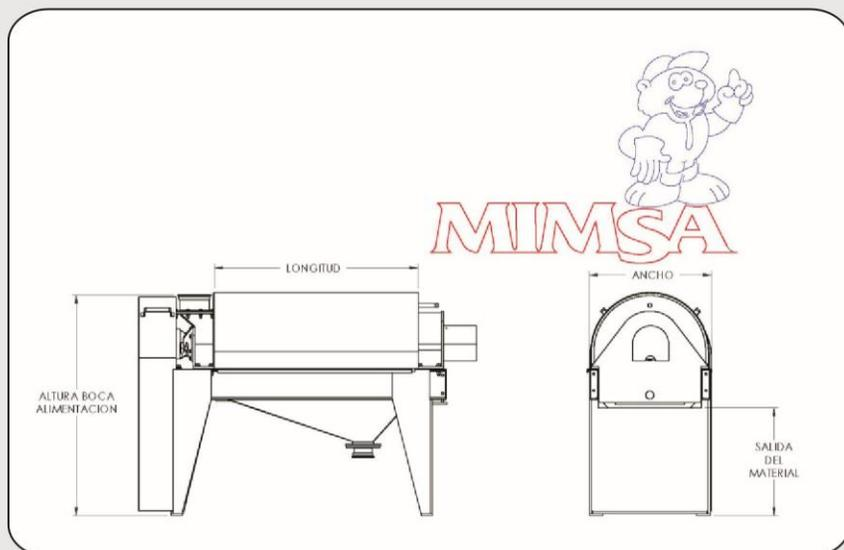
**DESCRIPCIÓN:** El equipo esta compuesto por una tolva guarda y tamiz desmontables, para un rápido lavado de acuerdo a la variedad de productos, fabricado con estructura robusta, que le da resistencia a la maquina, tamices elaborados con calibres reforzados, y acabados de grado alimento.
